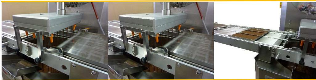
Les **TRANSMOULEURS MPT 6 et MTP 6 DP** sont compatibles avec tous les moules thermoformés et polycarbonate de dimensions 135 / 275 et 175 / 275 mm et d'une hauteur maximum de 25 mm.
