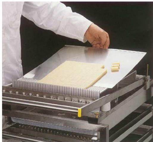
Les guitares type AS ont été étudiées pour les professionnels qui veulent un matériel fiable et simple à utiliser. Elles permettent de découper les abaisses rapidement et facilement. Le changement de cadre est très rapide grâce au système de verrouillage et au repérage des cadres par couleur. Avec une embase en aluminium et les cadres unifilaires réalisés en acier inox, elles permettent de faire une coupe nette et précise des intérieurs et canapés de formes carré, rectangle et losange.
