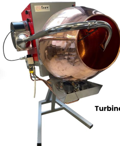
Turbina TP450 con ventilación
